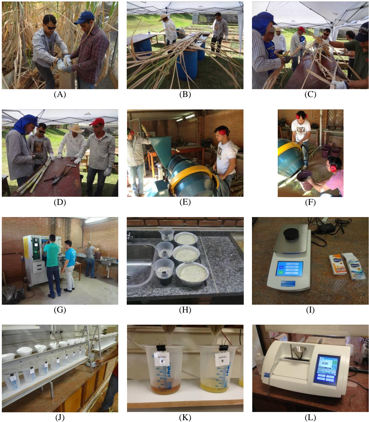
Figura 19 - Imagens da colheita do experimento e da análise tecnológica dos colmos. Coleta e armazenamento dos perfilhos improdutivos (A); Perfilhos produtivos cortados e já posicionados sobre a bancada (B); Detalhe da separação manual das diferentes partes do perfilho produtivo (C); Identificação dos colmos "limpos" após o trabalho de separação (D); Desintegração e homogeneização dos colmos (E); Detalhe da coleta da amostra homogeneizada representativa da parcela (F); Pesagem e prensagem do material para extração do caldo (G); Detalhe do caldo e bolo úmido obtidos após a prensagem (H); Refratômetro digital de bancada (Rudolph J47 ® ) para leitura de Brix (I); Vista geral do processo de clarificação (J); Detalhe do caldo clarificado (K); Sacarímetro digital (Autopol I Rudolph ® ) para leitura sacarimétrica (L)
