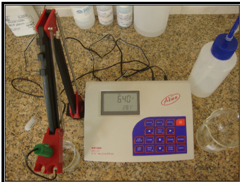
Figura 5. Peagômetro digital, usado para medir o pH da amostra.
