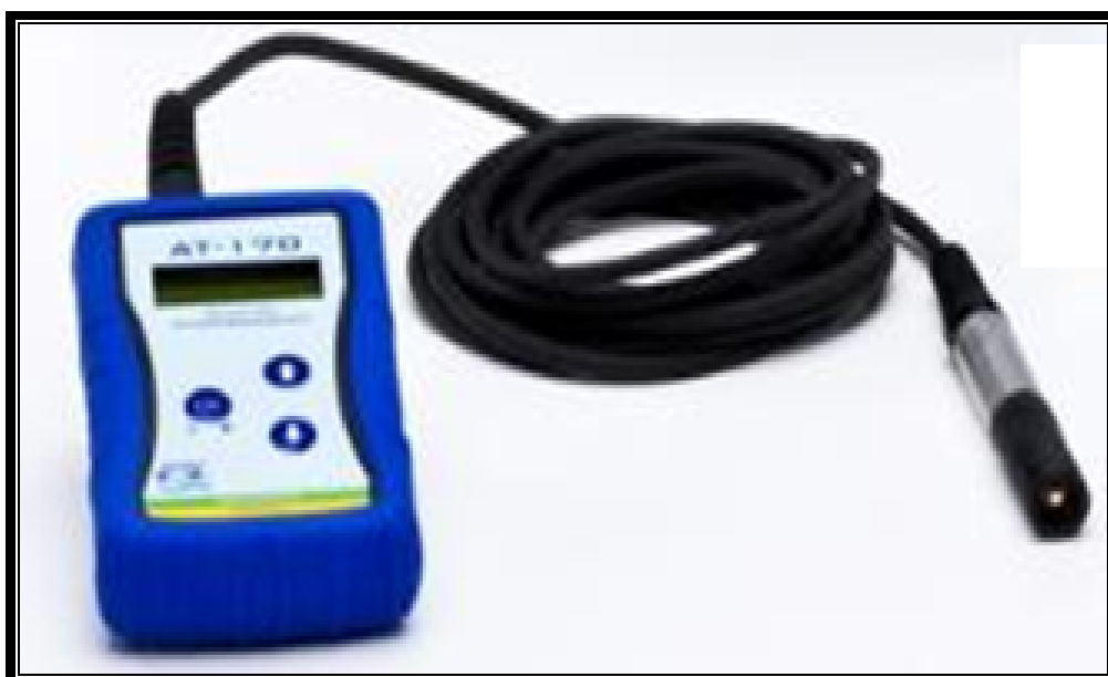
Figura 4. Oxímetro Digital da marca Alfa KIT, usado para medição da temperatura e Oxigênio dissolvido.
