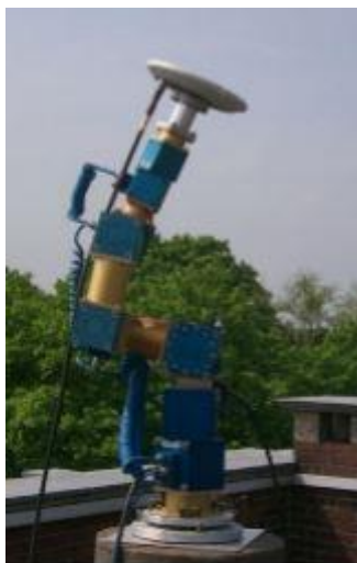
Figura 17 - Calibração Absoluta em campo de forma automatizada (Robô de Calibração)
