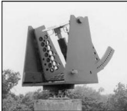
Figura 16 - Calibração Absoluta em campo de forma manual.
