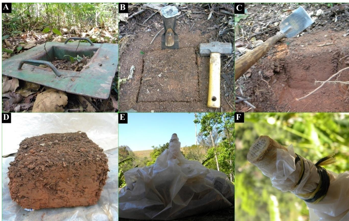
Figura 7 - Esquema ilustrativo da retirada de monólito de solo pelo método TSBF. A - Marcador de ferro; B - Corte do solo com talhadeira (0-20 cm); C - Trincheira; D - Monólito de solo; E - Saco de polietileno; F - Respirador. Fonte: Arquivo pessoal (2015).
