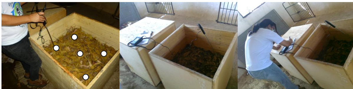
Figura 5. Processo de aferição de temperatura, em cinco pontos diferentes, com termômetro digital, seguida de anotação. IFSULDEMINAS – Câmpus Inconfidentes, 2014.
