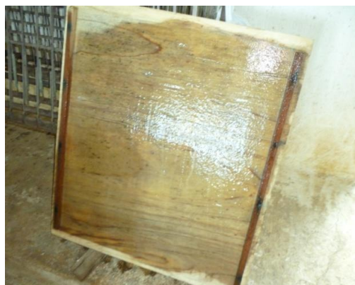
Figura 9 – Observação da umidade interna das composteiras devido ao molhamento do compensado. . IFSULDEMINAS – Câmpus Inconfidentes, 2014
