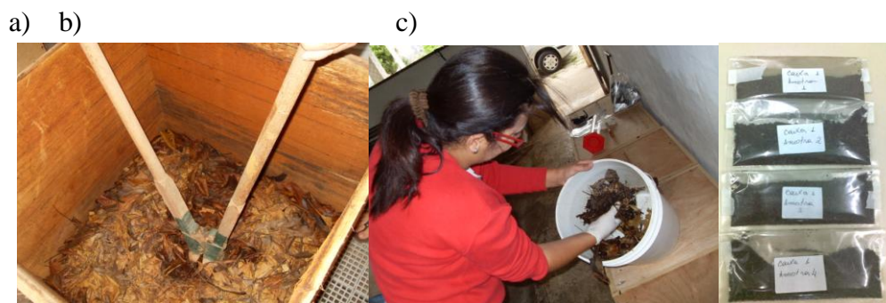
Figura 6. a) Retirada de amostras com auxílio da escavadeira, em diferentes profundidades, b) homogeneização das amostras e c) amostras prontas após processo de secagem e moagem, respectivamente. IFSULDEMINAS – Câmpus Inconfidentes, 2014
