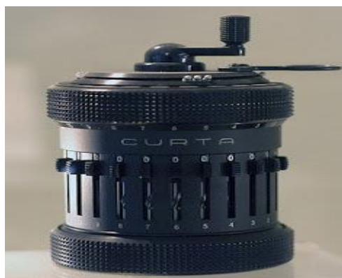
Figura 1.12: Curta (Disponível em: http://www.engquimicasantosp.com.br/2012/09/historia-da-calculadora.html )
