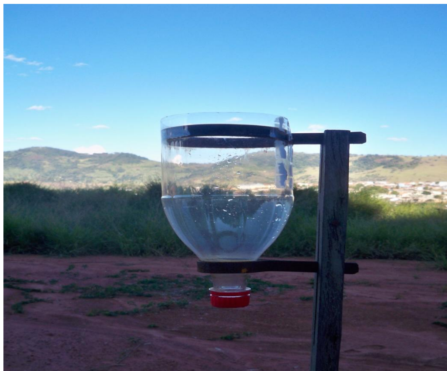
Figura 6 - Pluviômetro para coleta de precipitação externa (Fonte: elaboração própria)
