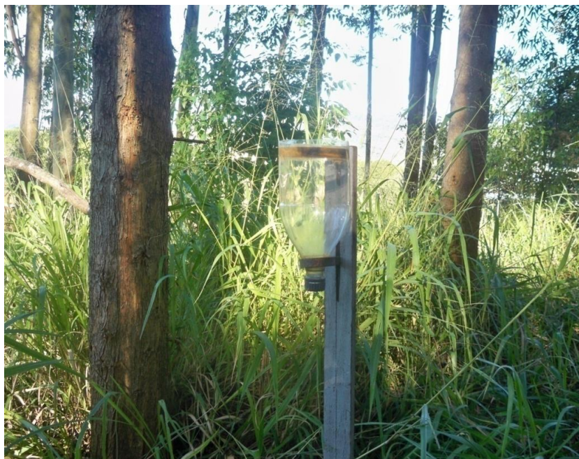
Figura 4 - Pluviômetro para coleta da precipitação interna ou efetiva (Fonte: elaboração própria)
