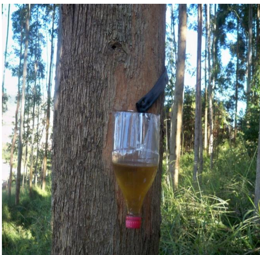
Figura 5 - Coletor de água precipitada escoada pelo tronco (Fonte: elaboração própria)
