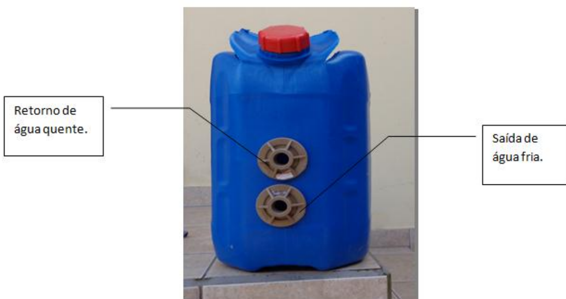
Figura 11: Reservatório de água utilizado nos dois sistemas de aquecimento. Fonte: Elaboração própria
