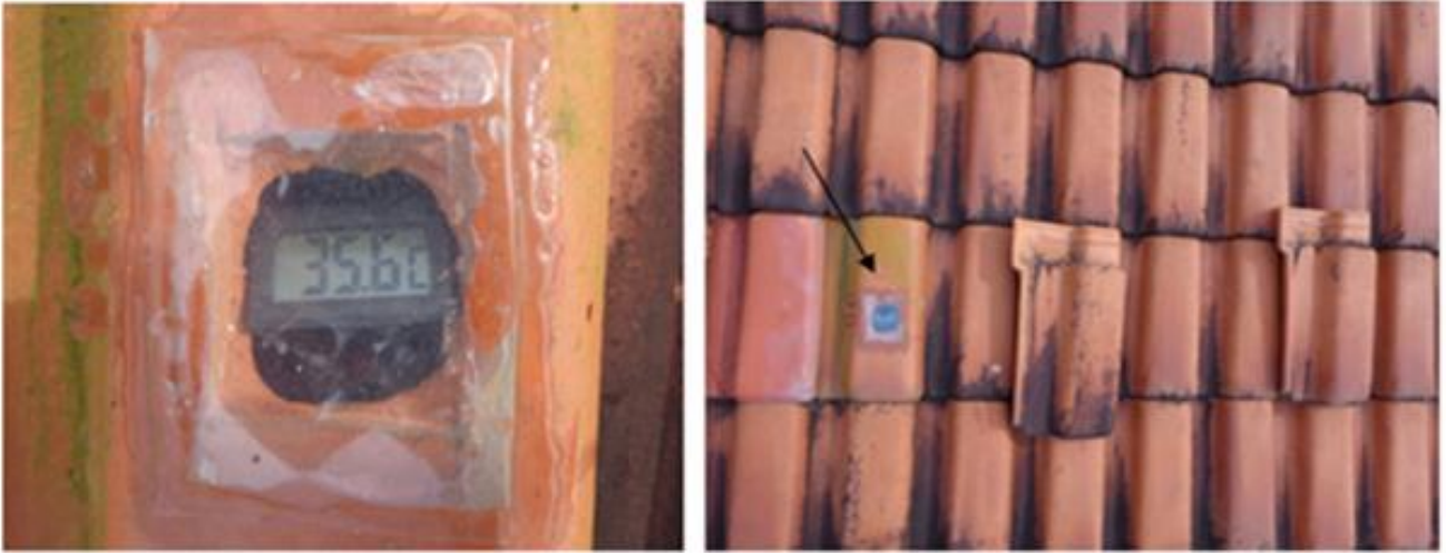
Figura 16: Termômetro digital instalado. Fonte: Elaboração Própria
