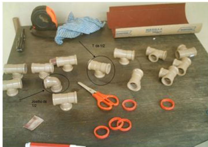
Figura 10: Joelhos, conexões, T e ferramentas de trabalho. Fonte: Elaboração própria
