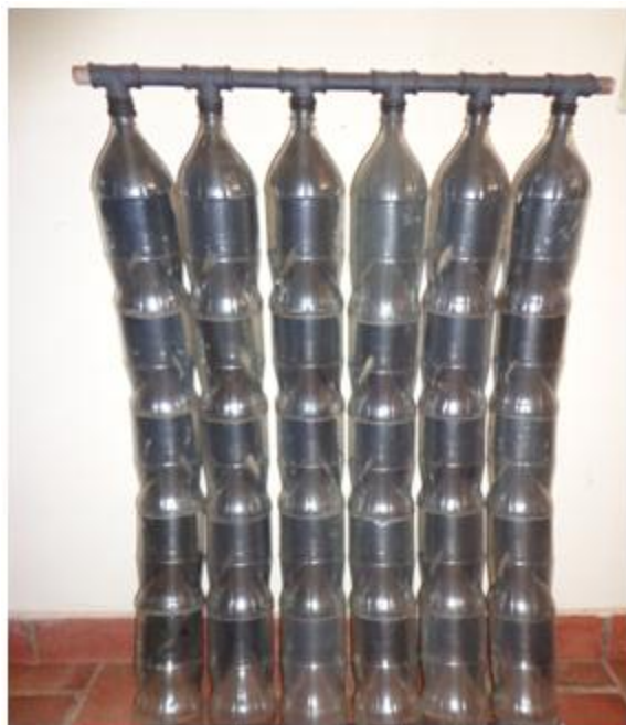
Figura 14: Aquecedor de PET pronto para instalação. Fonte: Elaboração própria
