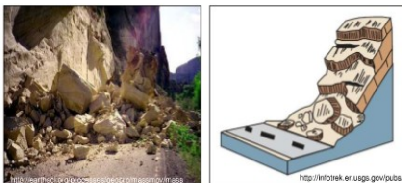
FIGURA 4: Fotografia e esquema do movimento tipo queda de blocos (Varnes, 1978).
