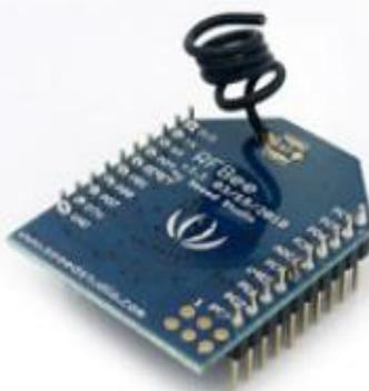
**Figura 12:** *RFBee* usado para realizar comunicação entre os sensores.
