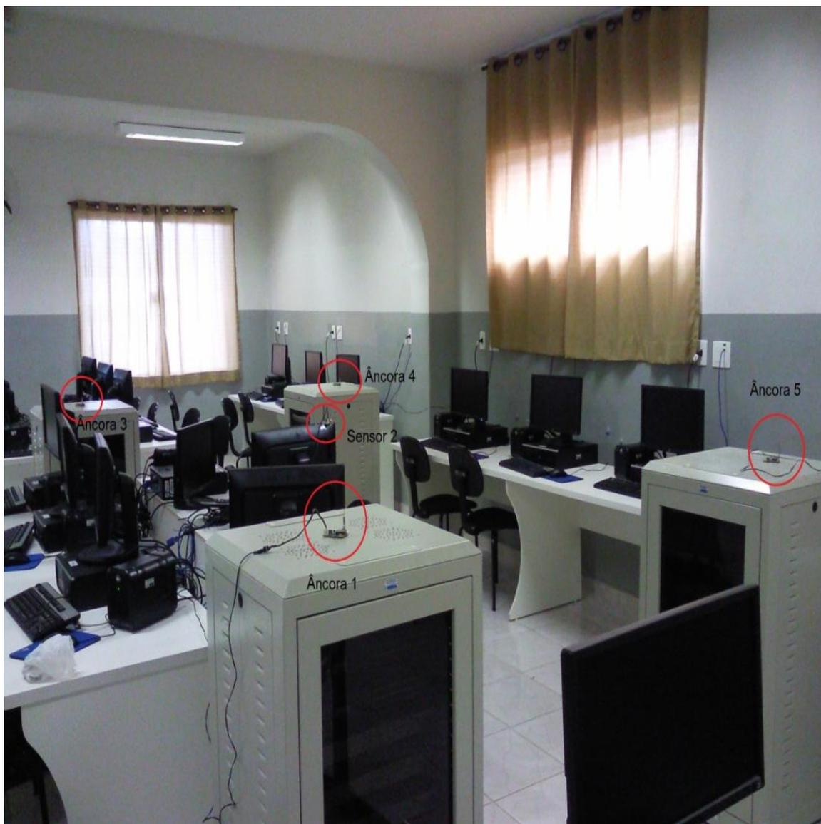
**Figura 19:** RSSF montada em laboratório para testes com o algoritmo de localização no cenário 1.
