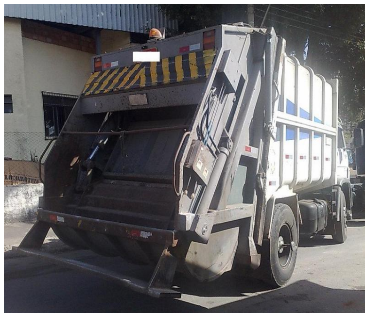
Caminhão do tipo compactador
