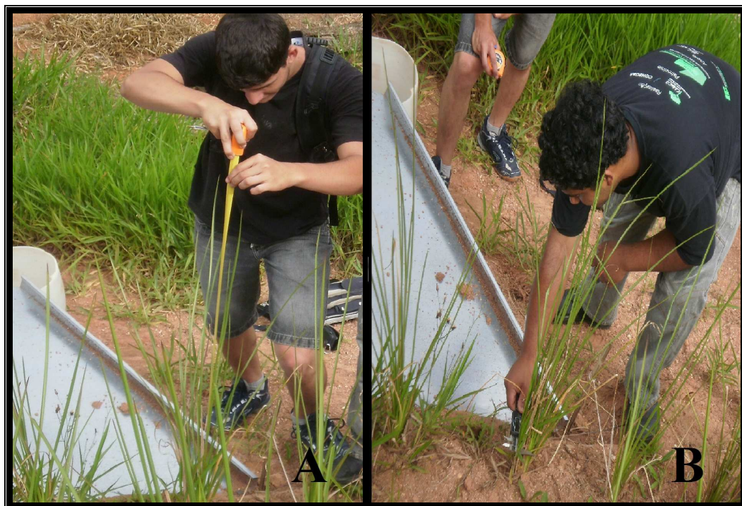
Figura 3. A) Avaliação da altura das plantas de vetiver, com fita métrica. B) Avaliação do diâmetro ao nível do solo das plantas de vetiver com auxílio de paquímetro digital.
