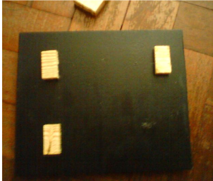
Figura 15: Pezinhos de madeira colados na chapa de ferro.
