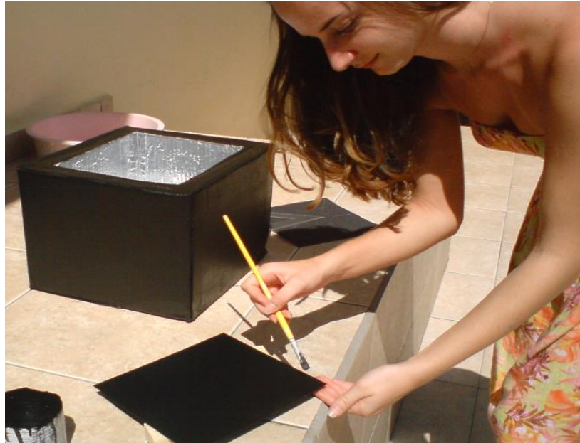
Figura 14: Chapa de ferro pintada de preto fosco.
