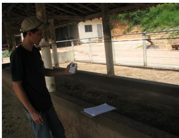
Figura 3. Medição da temperatura e umidade, ambiente campo, com o aparelho Thermo Hygro.
