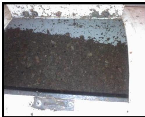
Figura 04 – Porta aberta no compostor rotor para inserção dos materiais
