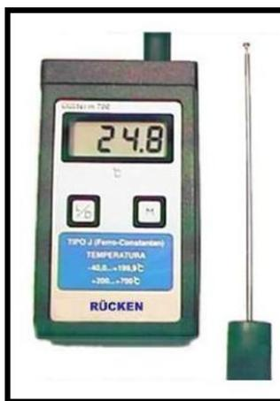
Figura 06 – Termômetro digital portátil RTDP – 700 – E
