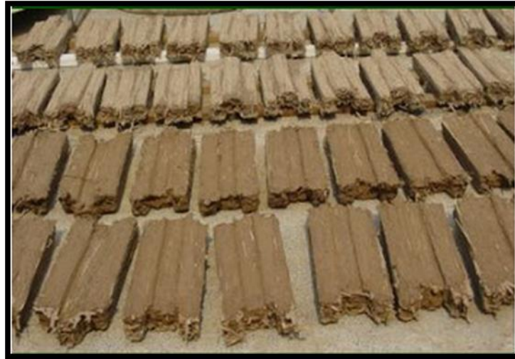
Figura 13. Tijolos confeccionados com argila e folhas da gramínea vetiver (Fonte: TVNI, 2013).
