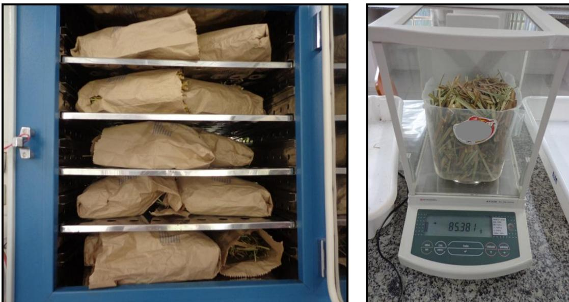
**Figura 07.** Secagem das amostras em estufa e pesagem para obtenção da MSa (Fonte: Arquivo Pessoal).
