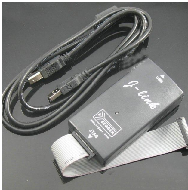
Figura 7. Gravador/depurador JTAG para microcontroladores ARM.
