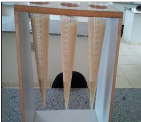
Figura 9: Processo Fenton – C1. Resíduo adicionado das substâncias oxidantes no cone Imhoff. Fonte: elaboração própria.
