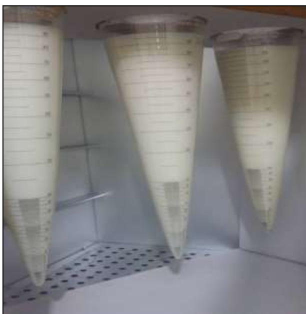
Figura 10: Processo Fenton – C2 e C3. Resíduo adicionado das substâncias oxidantes no cone Imhoff dentro da estufa. Fonte: elaboração própria.
