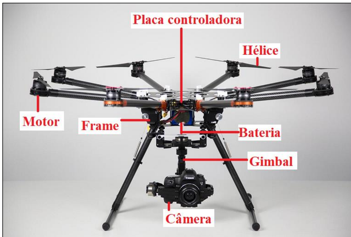
Figura 09. Multirroto octacóptero e componentes
