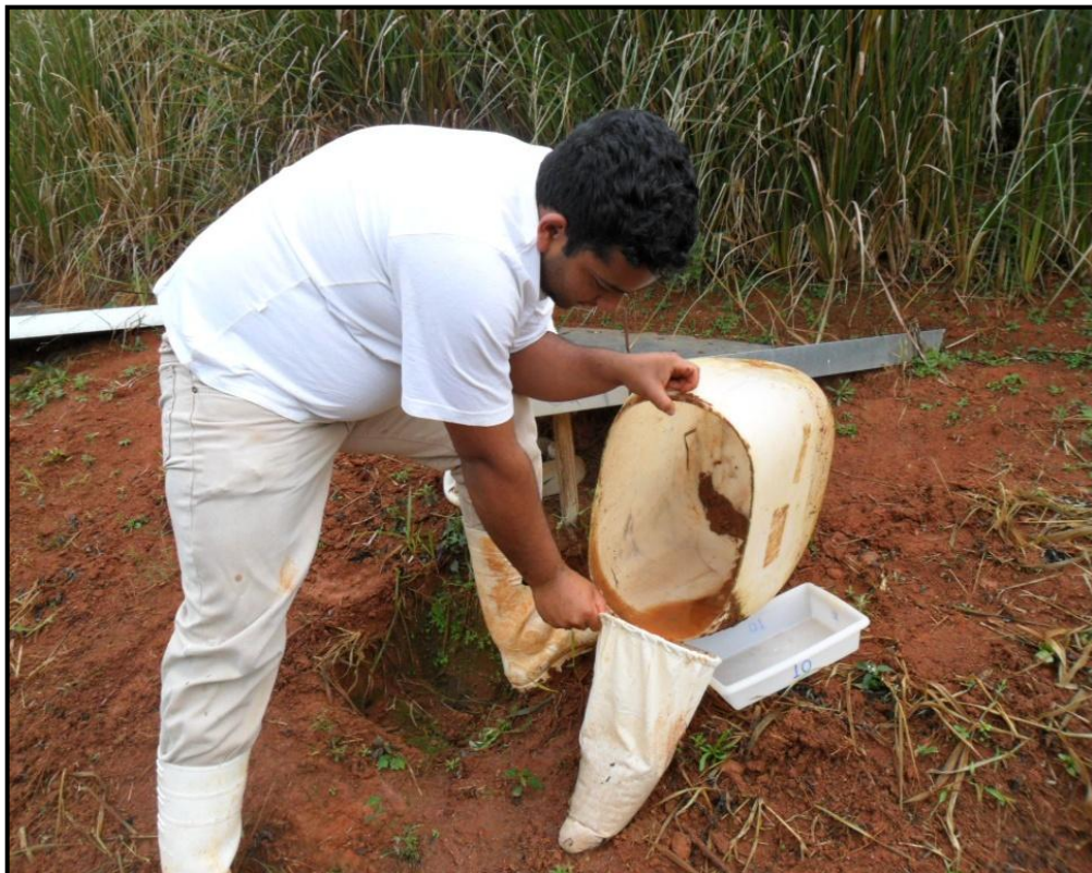
Figura 9. Passagem da solução coletada por um coador para separação do solo.
