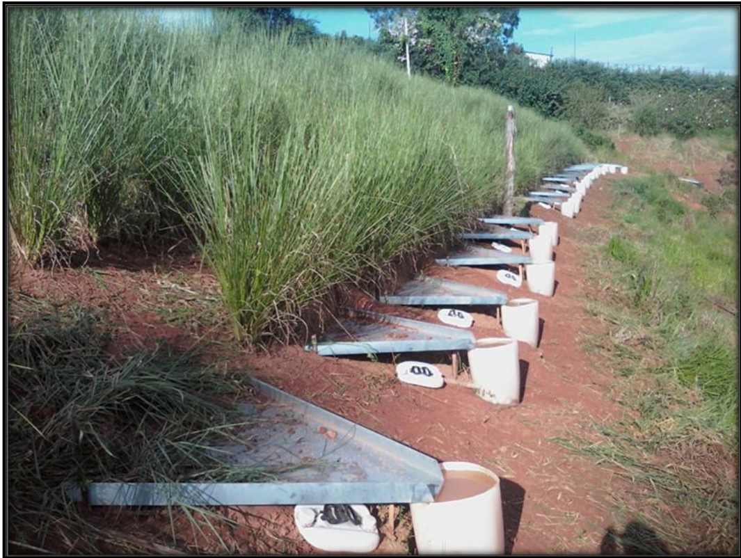
Figura 5. Calhas e baldes de 50 L na parte inferior das parcelas no experimento, Inconfidentes/MG.
