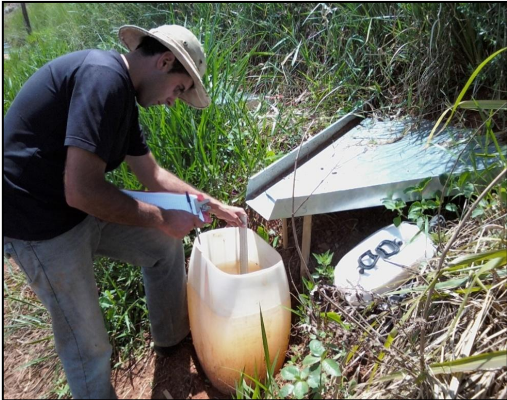
Figura 6. Medição do volume da solução coletada com régua especial graduada.
