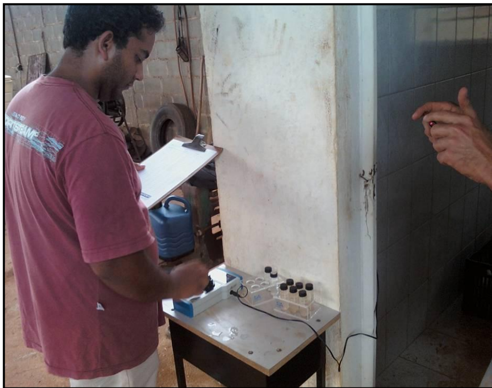
Figura 8. Análise de turbidez da água, utilizando-se turbidímetro.
