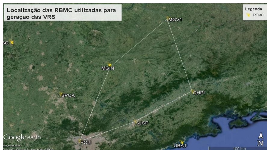
Figura 12 - Localização das bases RBMC utilizadas para a geração das VRS
