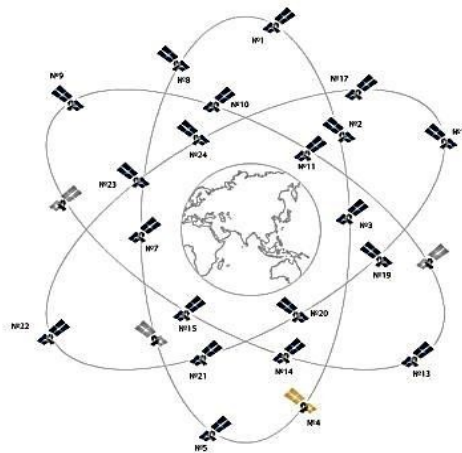
Figura 2- Constelação dos satélites do sistema GLONASS
