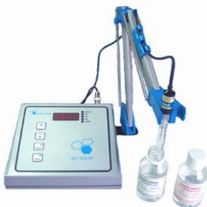
Figura 13. Peagâmetro digital usado para medir o pH da amostra (Fonte: Arquivo pessoal).
