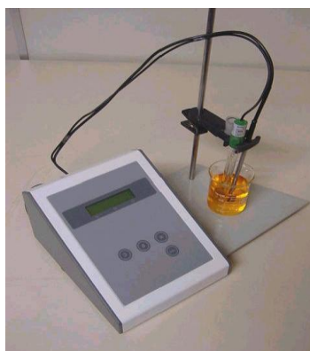
Figura 11. Condutivímetro digital, utilizado nas análises de Condutividade Elétrica e Sólidos Totais Dissolvidos (Fonte: Arquivo pessoal).
