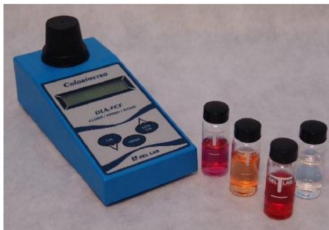
Figura 12. Colorímetro Plus usado para medir a cor (Fonte: Arquivo Pessoal).
