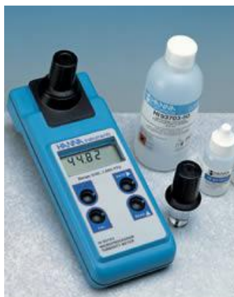
Figura 10. Turbidímetro utilizado para determinação da turbidez (Fonte: Arquivo pessoal).
