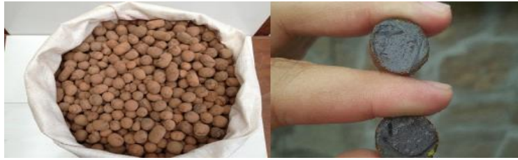
Figura 2- Argila expandida cedida pela empresa Cinexpan. Fonte: Elaboração própria, 2015.
