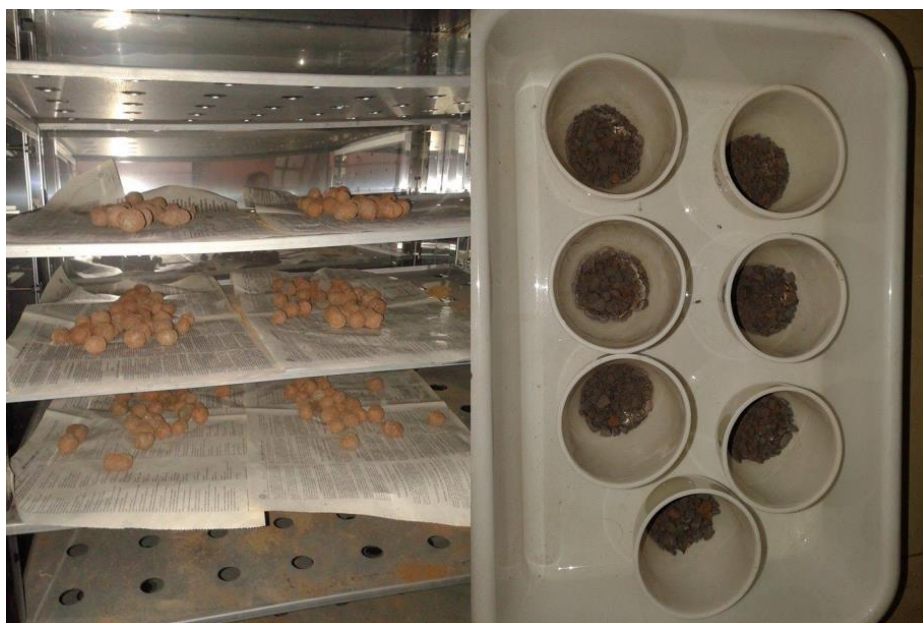
Figura 7- Argila em estufa e argila quebrada e separa nos cadinhos para realização de análises. Fonte: Elaboração própria, 2015.
