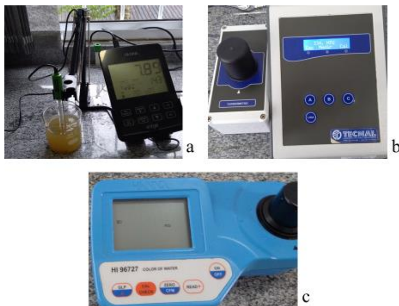
Figura 7: Análises feitas no efluente. a. pH b. Turbidez. c. Cor. Fonte. Autor
