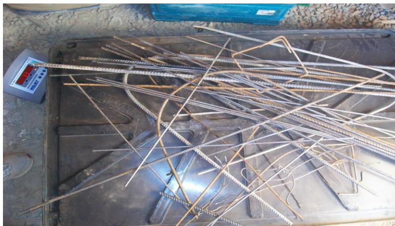
Figura 10: Pesagem das ferragens: Fonte: (Arquivo pessoal)
