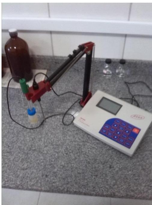
Figura 4: Peagâmetro Digital PG 1800 marca Gehaka (Fonte: autoria própria)
