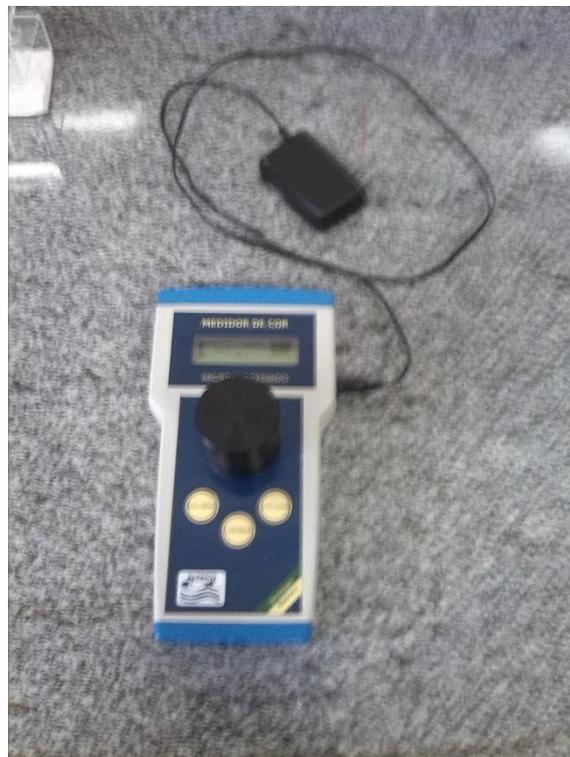
Figura 2: colorímetro Plus marca Alfa Kit (Fonte: autoria própria)
