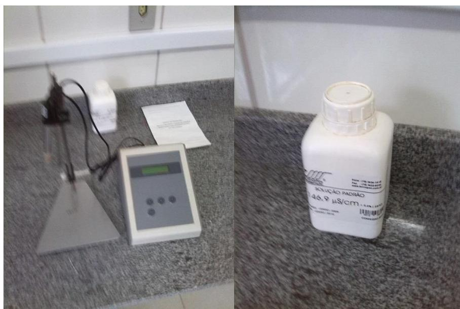
Figura 5: Condutivímetro Digital 150 e solução padrão 149,9. (Fonte: autoria própria)
