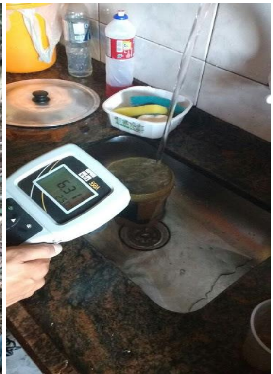
Figura 7 - Medição do parâmetro oxigênio dissolvido e temperatura: A - Nascente e B -Torneira
