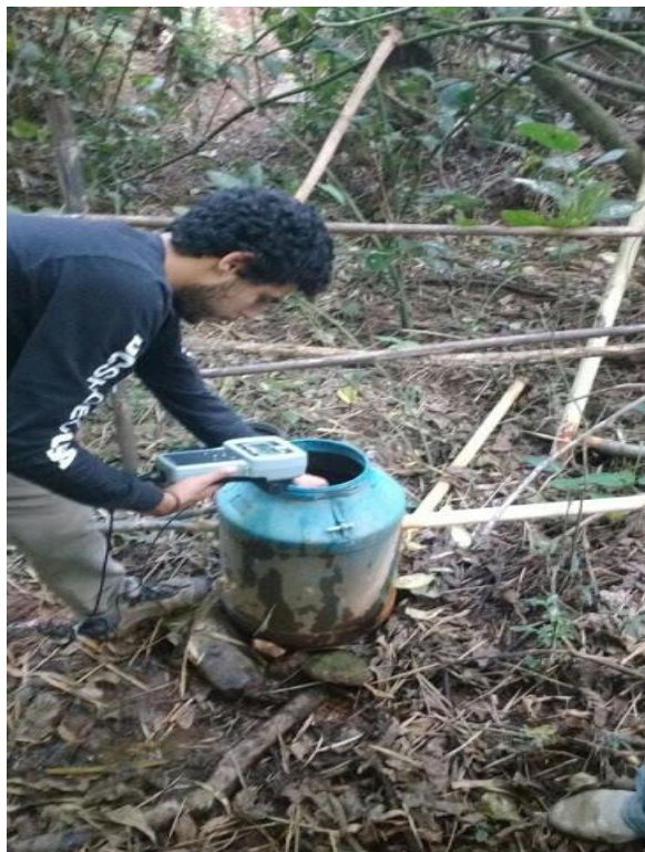
Figura 7 - Medição do parâmetro oxigênio dissolvido e temperatura: A - Nascente e B -Torneira
