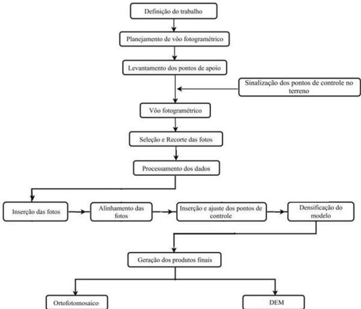
Figura 5 - Esquema geral das operações do projeto fotogramétrico
