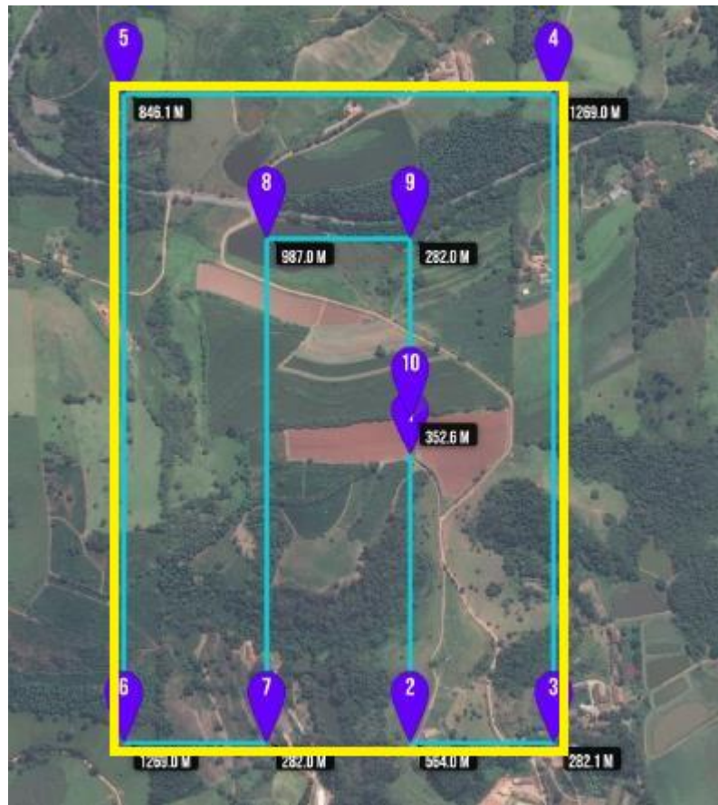
Figura 7 - Caminhamento percorrido pelo Drone quando na realização do voo.
