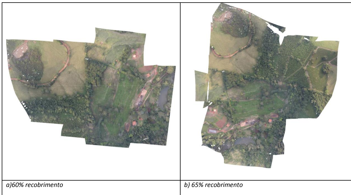
Figura 17 - Ortofotos geradas com diferentes sobreposições longitudinais: 65% e 60%.
