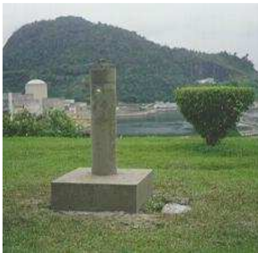
Figura 18 - Pilar com chapa de identificação fixada no seu corpo.
