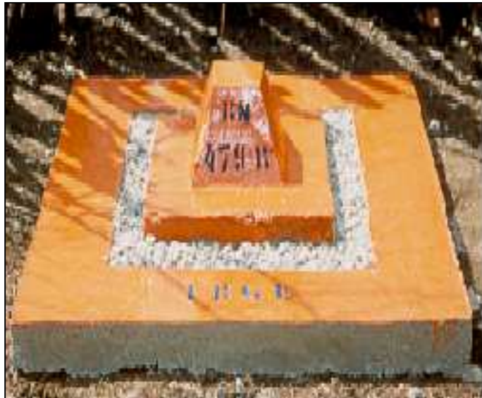
Figura 10 - Marco padrão IBGE com identificação em baixo relevo.
