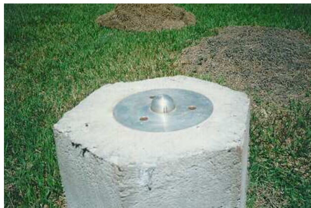
Figura 23 - Dispositivo de Centragem forçada padrão UFPR fechado.
