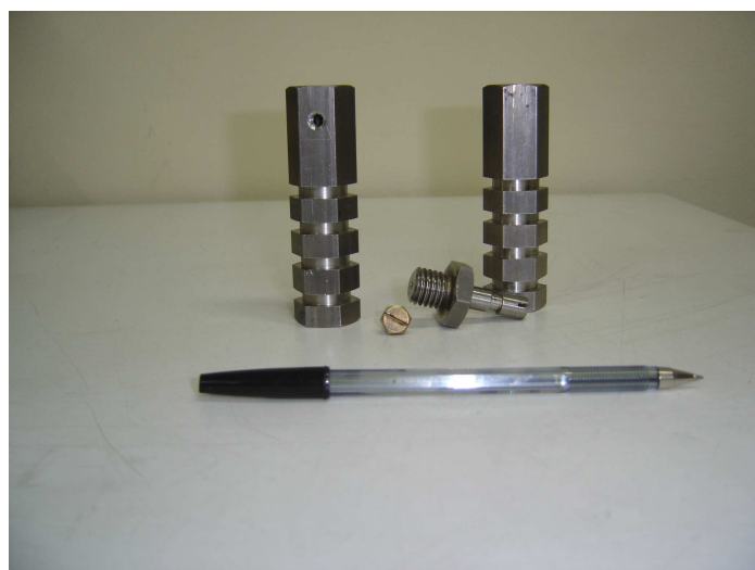
Figura 25 - Componentes do pino de centragem forçada padrão IBGE.
