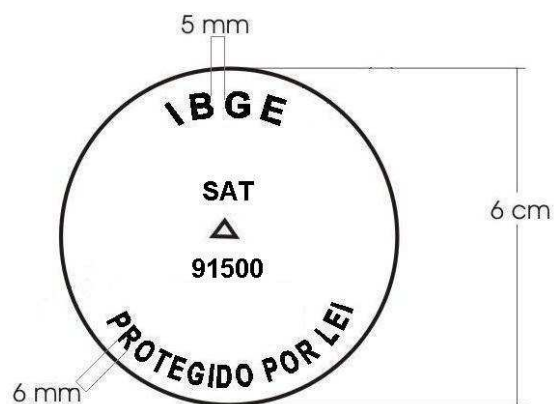
Figura 4 - Exemplo de Chapa de Estação Satélite.
