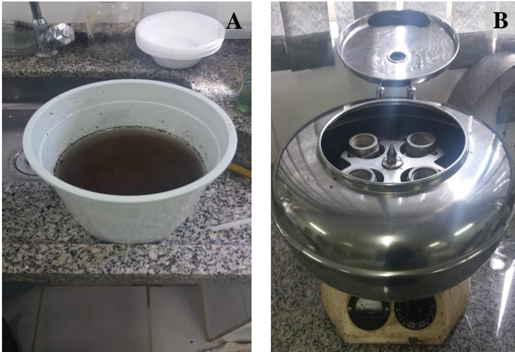
Figura 5. A - Solo misturado com 1,5 L de água de torneira; B - Centrífuga com tubos contendo o solo passado nas peneiras.
