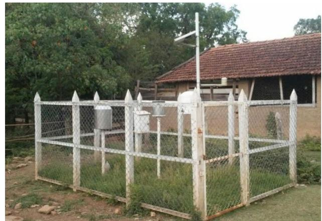
**Figura 03** – Estação Pluviométrica de Inconfidentes/MG.
