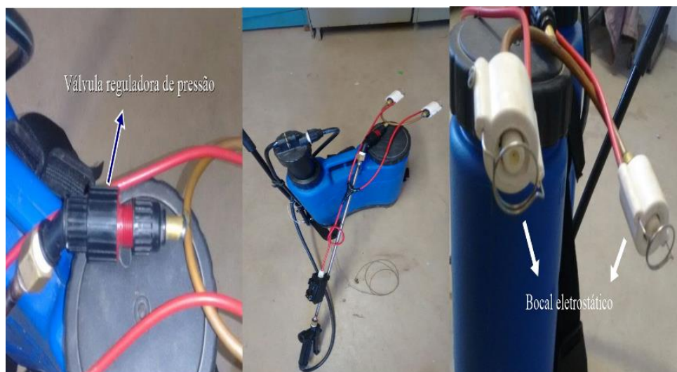
Figura 7 – Pulverizador Magnojet costal manual com kit eletrostático, Inconfidentes – MG 2017.
