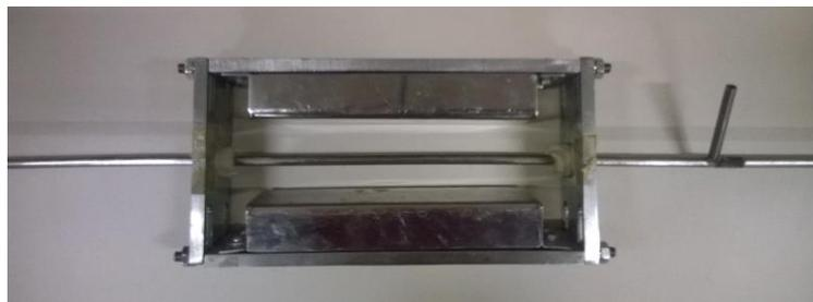
**Figura 3** – Foto do magnetizador de indução variável em sua maior distância do tubo de circulação o que acarreta um campo de 50 Gauss.
