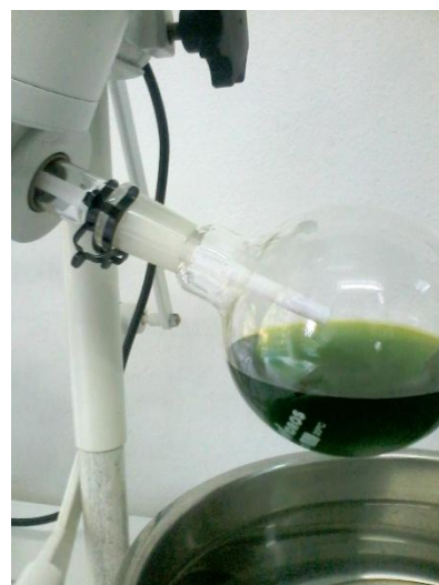
Figura 4: Extração do extrato, com o evaporador rotatório. IFSULDEMINAS – Inconfidentes, 2015
