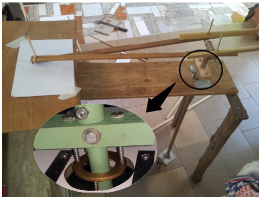
(c) O suporte para o pêndulo B1 , foi substituído pelo gimbal feito de latão (material de cor dourada na foto), permitindo o movimento livre do mesmo.
