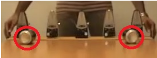
(b) O sistema é acoplado utilizando as latas indicadas pelo círculo vermelho.
