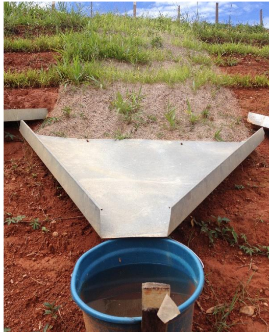
Figura 5. Método de Coleta da Água através de calha do tipo Gerlach.
