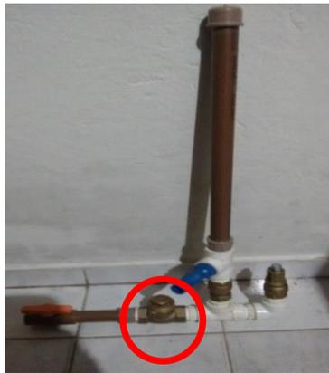
**Figura 6:** Carneiro hidráulico de PVC Protótipo (Fonte: Autoria própria)
