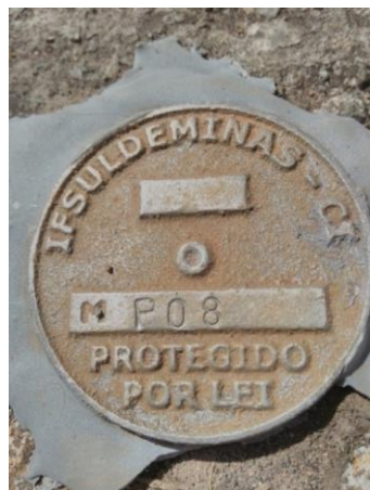
Figura 7 - Chapa de aço com a identificação do ponto.
