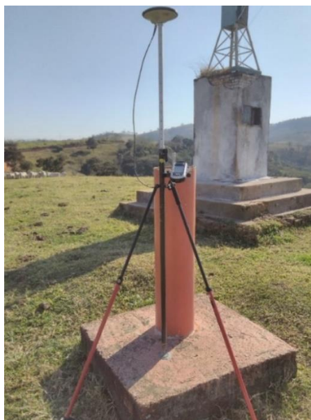
Figura 17 - Imagem do ponto P23 localizado na sapata do marco 93953 do IBGE.
