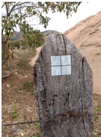
Figura 18 - Pontos auxiliares materializados por fitas adesivas refletivas
