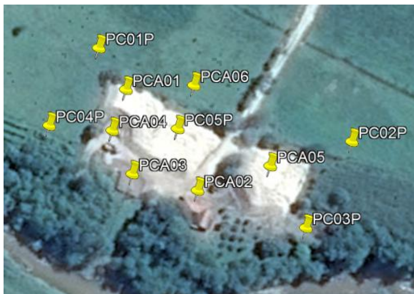
Figura 24 - Distribuição dos pontos de controle e controle altimétrico
