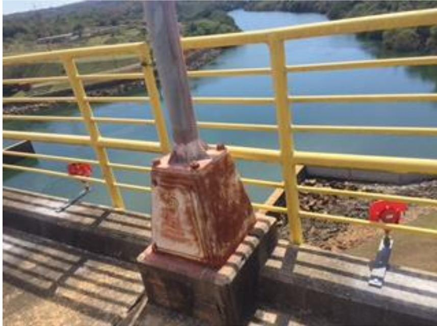
Figura 23: Ilustração dos marcos e prismas utilizados no monitoramento.
