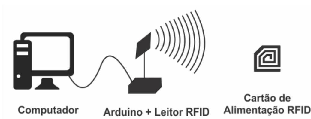
**Figura 7: Esquema simplificado do funcionamento do sistema, construído utilizando o Software CorelDRAW X4. Fonte: Autoria própria.**
