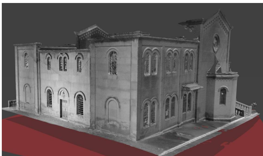
Figura 33 – Nuvem de pontos renderizada do fundo da igreja Fonte: Autodesk ReCap 360 Pro Versão Estudantil.
