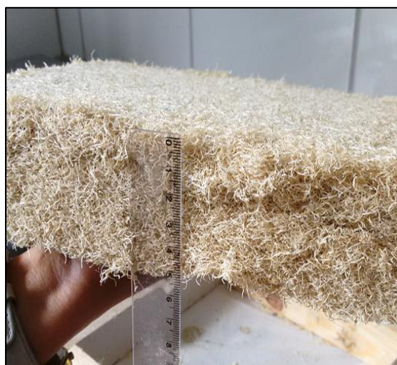
Figura 14: Medição da espessura de cada manta.
