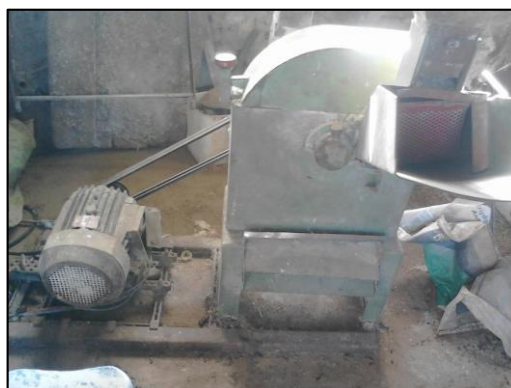
Figura 7: Triturador de grãos utilizado para moagem da fibra de bucha vegetal ( Luffa cylindrica )
