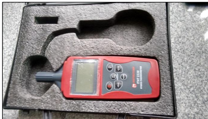
Figura 12: Medidor de temperatura e humidade utilizado para medir temperatura e humidade do laboratório e do protótipo.
